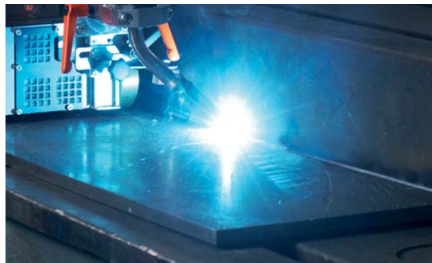
Konstante Fahrgenauigkeit durch tachogeregelten Antrieb.
