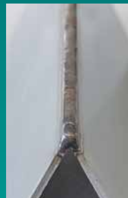
Hochfrequenz-Pulsen für perfekte Ecknähte
